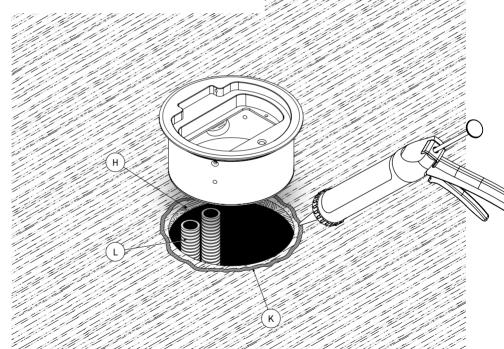
Danach die Geräte anschließen und den Geräteträger ②, sowie den Deckel ① wieder in das Gehäuse ③ einschrauben. Mithilfe der Gewindestifte (rot markiert), die Dose im Hohlboden verankern. Die Bodensteckdose ist nun erfolgreich eingehaut
